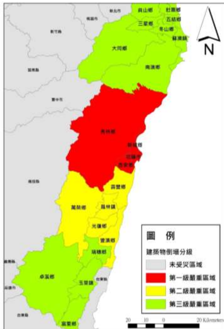
圖 9 東部琉球隱沒帶沒帶發生規模 8.0 地震地建築物倒塌分級
